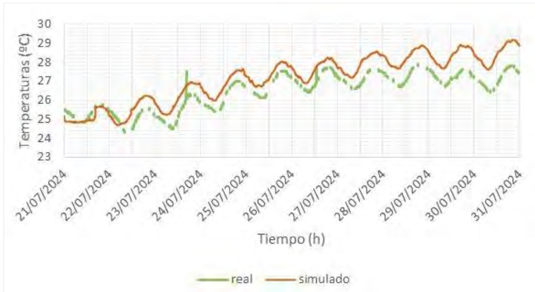
Figura 22. Temperaturas simuladas vsus reales para el punto 11 del packing. Caso validación verano
